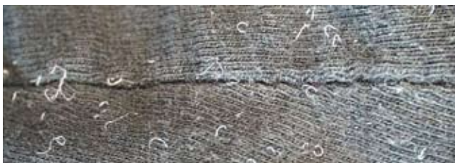
Aus dem Gewebe herausgetretene Elasthanfäden
